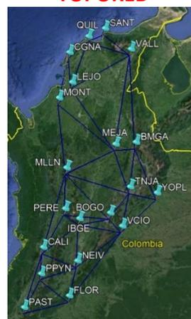
**TOPORED** es un producto propiedad de **CASA DEL TOPOGRAFO S.A.S.**, Constituido por una Red CORS activa con rastreo continuo de observaciones GNSS, capaz de emitir correcciones en protocolo NTRIP, compuesta por 22 estaciones permanentes distribuidas a lo largo de la República de Colombia. Para mayor información contáctanos al Teléfono: (1) 457 2128, Celular: 322 9471086 o visita: [www.casadeltopografo.com/topored](http://www.casadeltopografo.com/topored)
